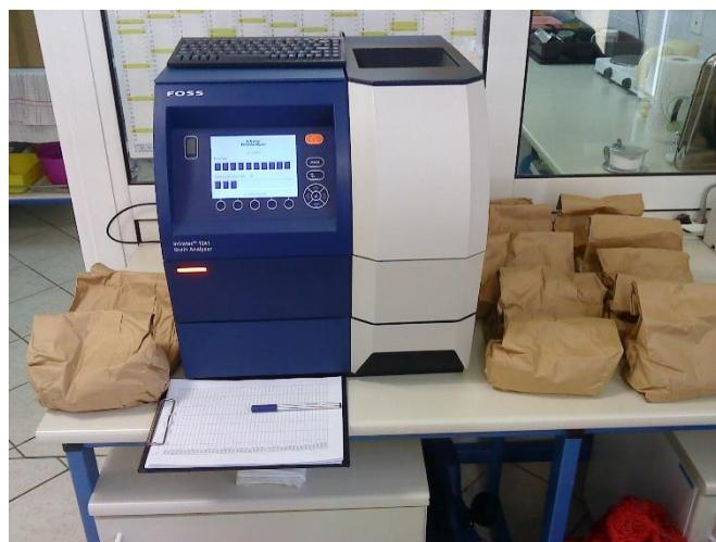
Slika 7. Infratec Grain Analizator, uređaj za određivanje kvalitete zrna pšenice
