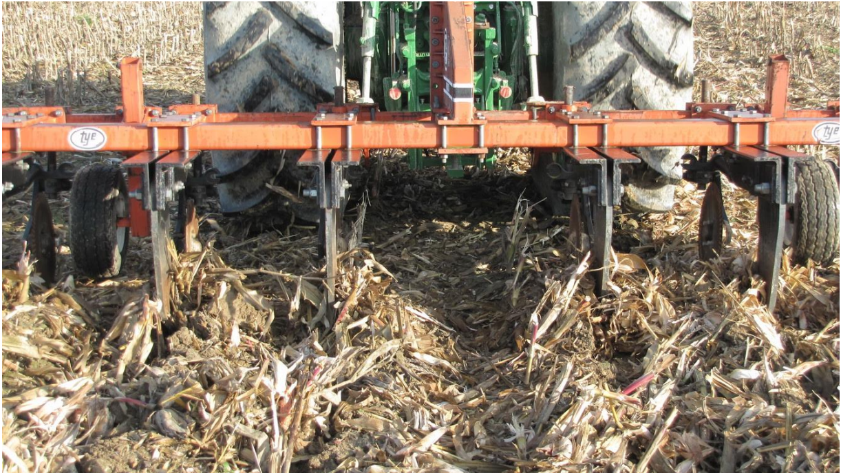
Slika 3. Obrada tla rahljenjem (izvor: Jug, D.)
