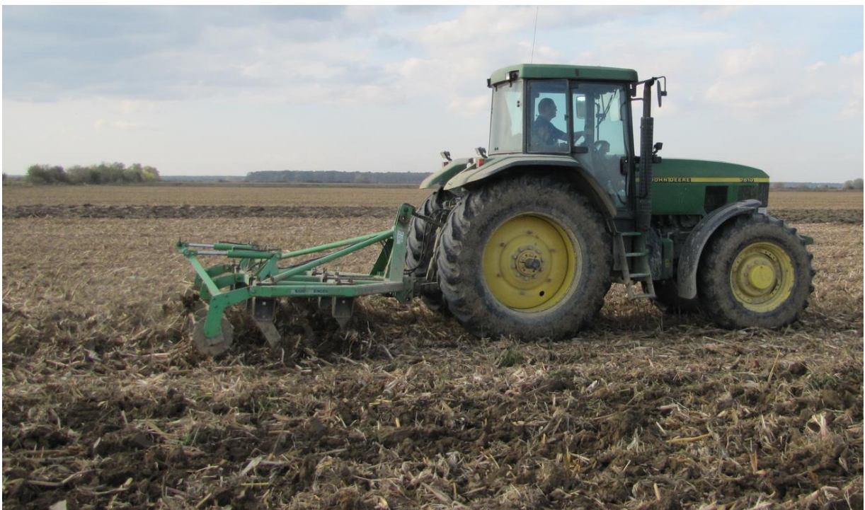
Slika 2. Obrada tla podrivanjem (izvor: Jug, D.)
