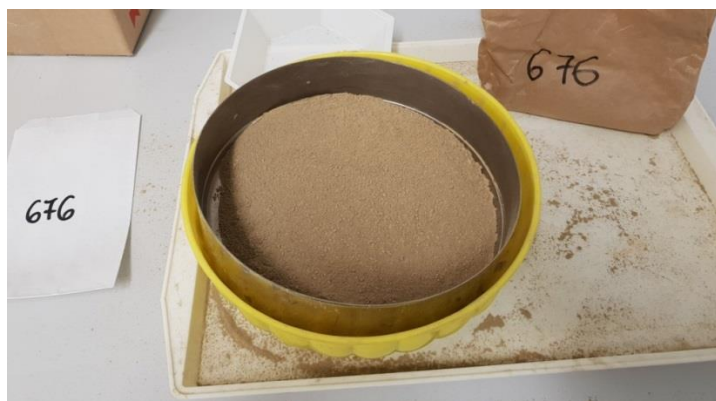
Slika 4. Prosijavanje uzorka (Izvor: autor)
