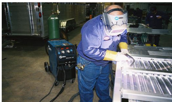
Slika 13. MIG zavarivanje aluminijskih legura
