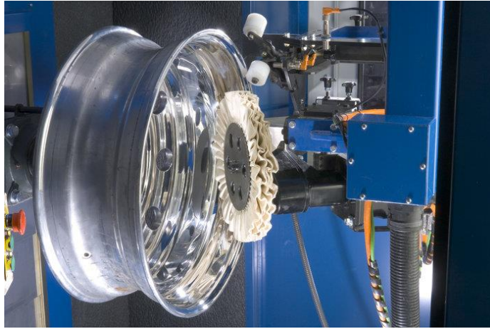
Slika 6. Postupak poliranja aluminijskih legura
