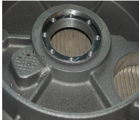
Slika 2. Predmet od aluminijske legure izliven u pijesku ( http://uneko.webcode.cz/en/foundry/# )
