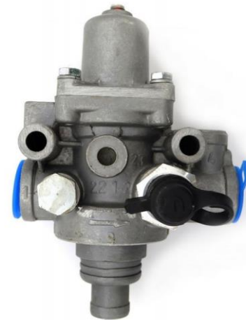
Slika 22. Sigurnosni ventil izrađen od aluminijske legure ( https://roko.si/prodajni_program/rezervni_deli/deli_za_traktorje/zracni_sistemi/6525/ventil_z_raka_regulator_pritiska_kompresorja_5221100110/ )
