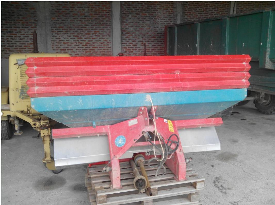
Slika 16. Rasipač mineralog gnojiva "Sulky DPX Prima"
