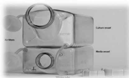
Slika 14. Imerzni bioreaktor - posuda za biljke (gornja) i za medij (donja)
