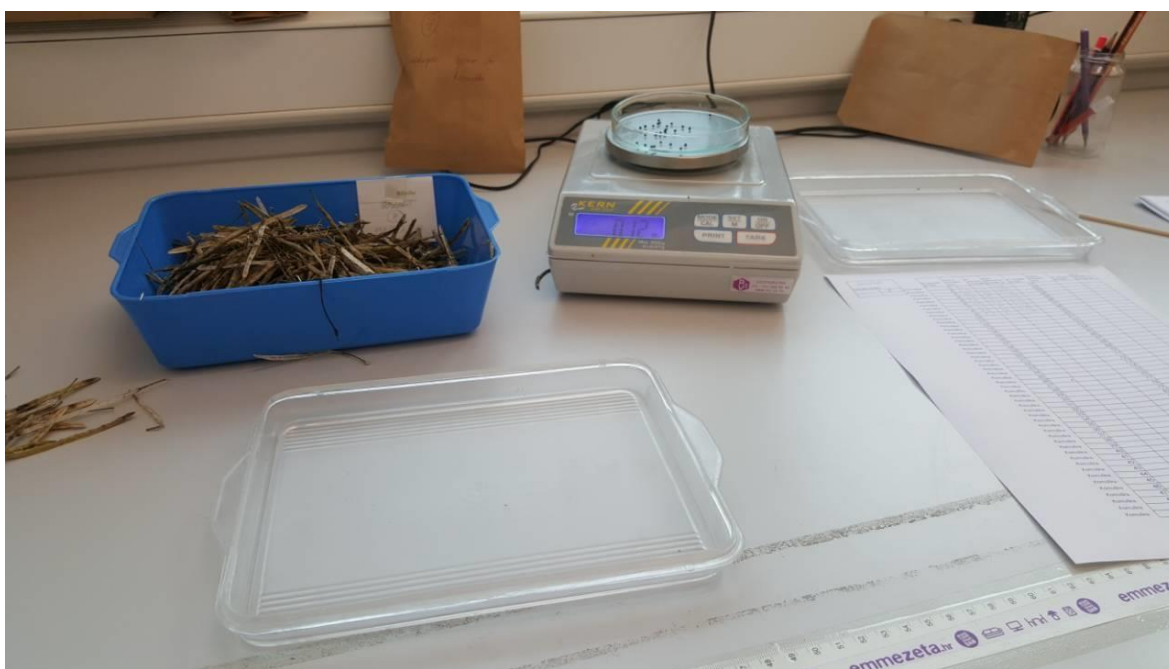
Slika 11. Mjerenje dužine kumuške i određivanje mase sjemenki po kumuški uljane repice (Anđelić, E., 2018.)
