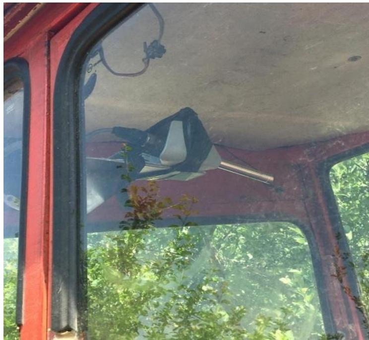
Slika 8. Zvučna sonda postavljena na desnoj strani traktora
