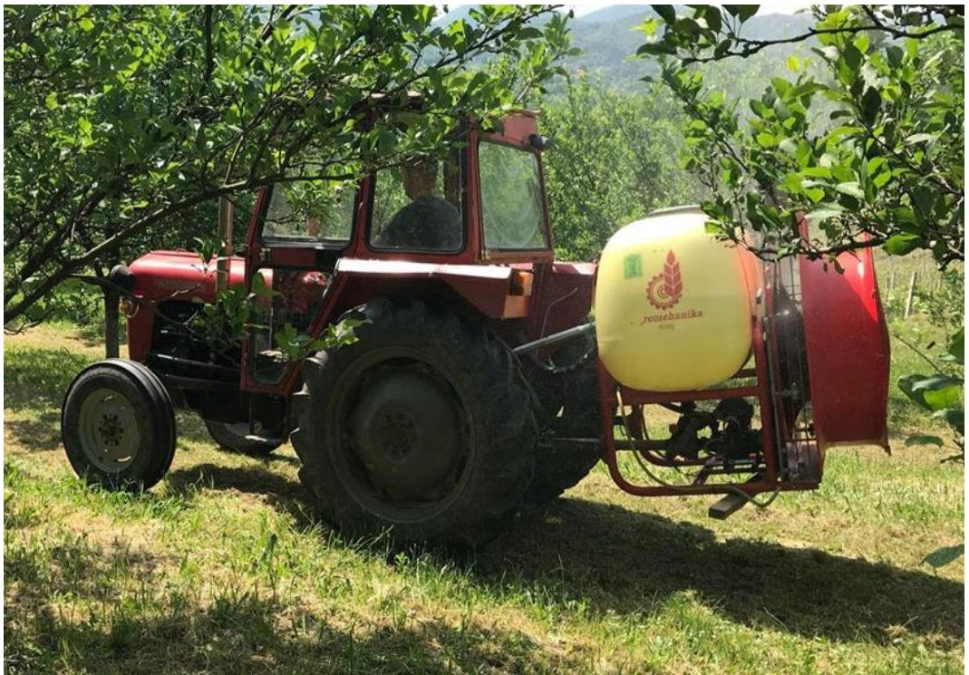
Slika 5. Raspršivač Agromehanika pri radu
