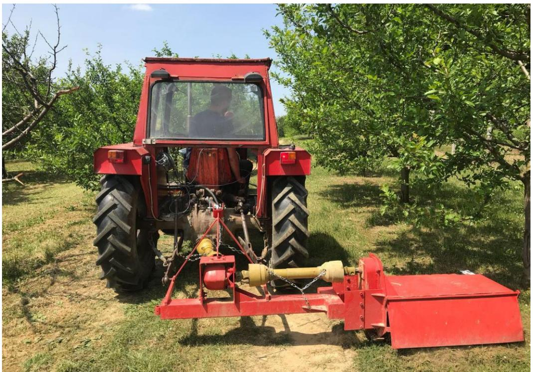
Slika 6. Bočna freza u radu
