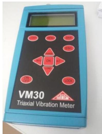
Slika 9. Uređaj za mjerjenje vibracija MMF VM30 (vlastita fotografija)
