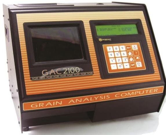
Slika 6. Električni vlagomjer (<http://www.dickey-john.com/product/gac-2100-agri/>)
