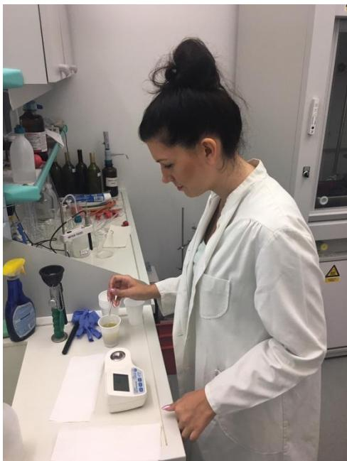
Slika 18. Mjerenje sadržaja šećera digitalnim
