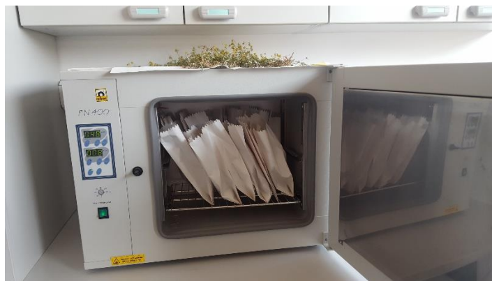
Slika 11. Sušenje uzoraka u sušioniku (fotografija: T. Škorić, 2018.)
