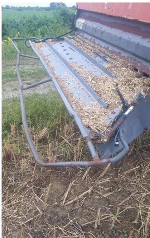
Slika 11. Prikaz razbacivača („lepeze“) žetvenih ostataka kombajna „ MF Cerea 7274 “ Izvor: Nikola Papac
