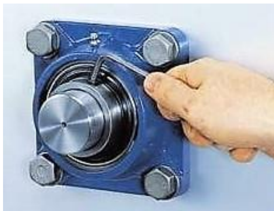
Slika 33. Zatezanje vijka na unutarnjem prstenu Y-ležaja
