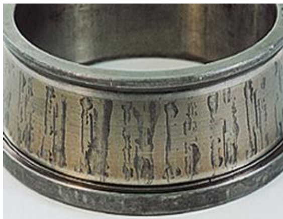
Slika 19. Primjer korozije kotrljajućeg ležaja
