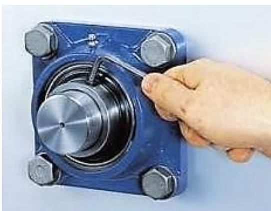
Slika 33. Zatezanje vijka na unutarnjem prstenu Y-ležaja
