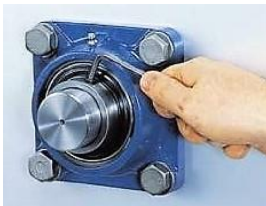
Slika 33. Zatezanje vijka na unutarnjem prstenu Y-ležaja
