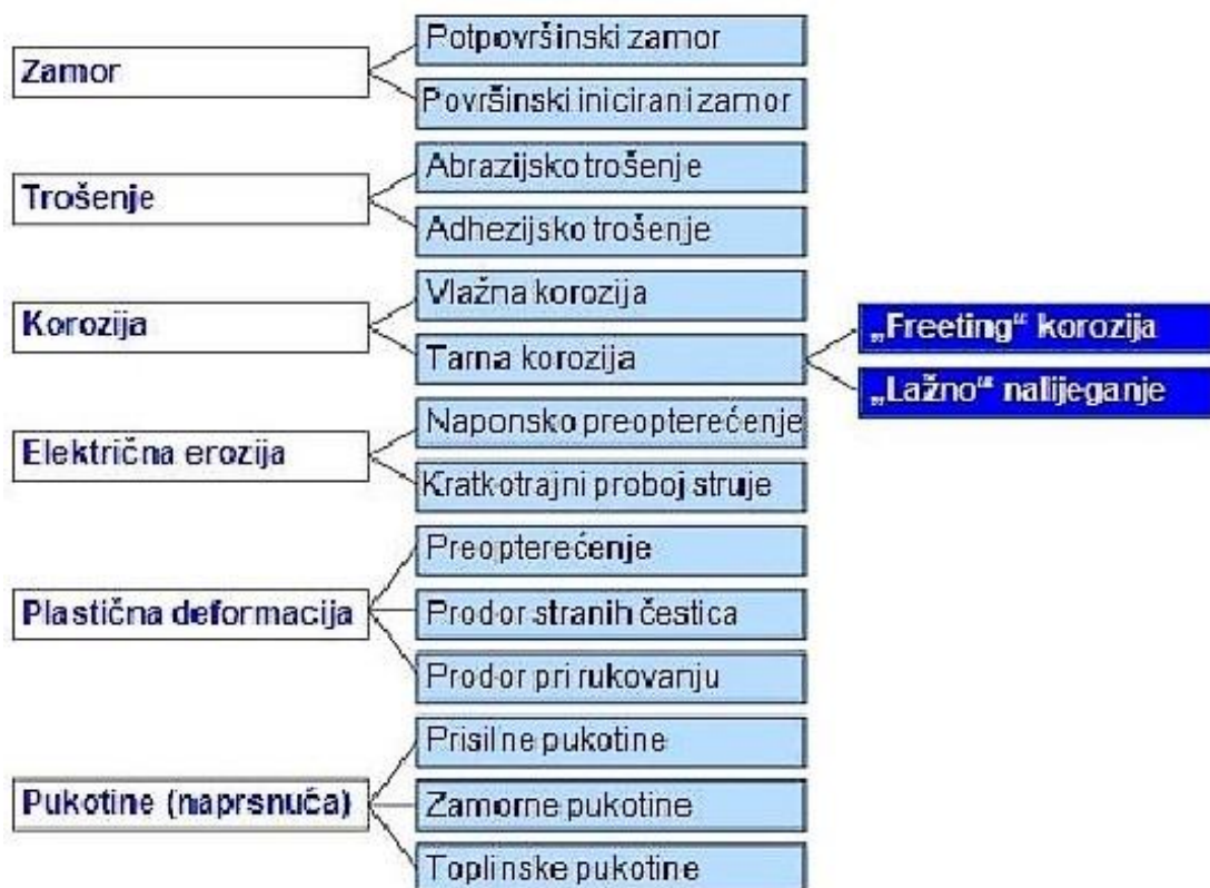
Slika 16. Podjela oblika trošenja kotrljajućih ležaja prema ISO 15243-2004E (Izvor: https://www.sis.se/api/document/preview/906198/ )
