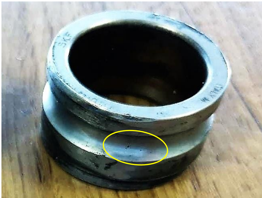
Slika 41. Zamorno trošenje unutarnjeg prstena ležaja (Fotografija: Đurkić, 2018.)
