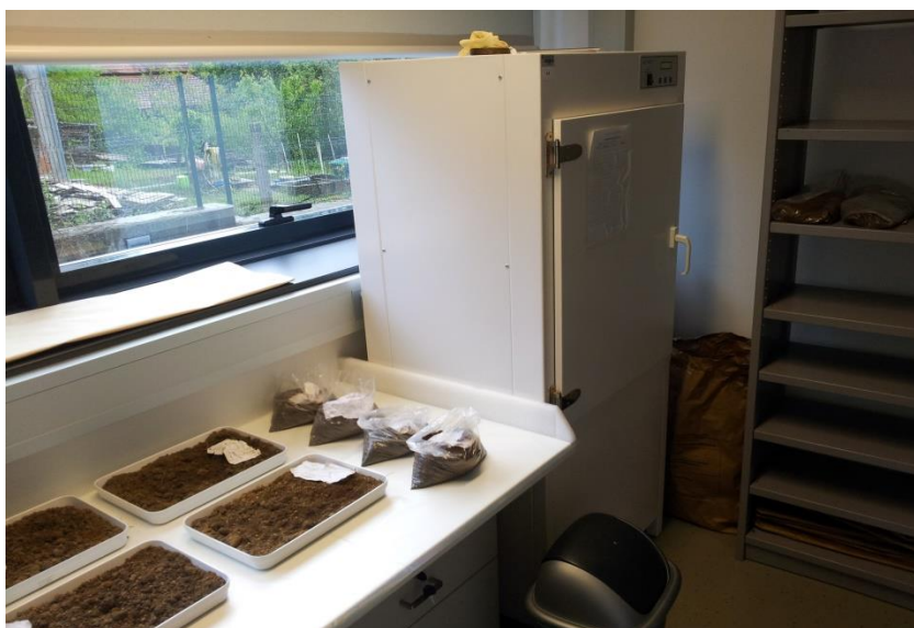
Slika 4. Sušenje uzoraka tla (Izvor:www.hcphs.hr.)
