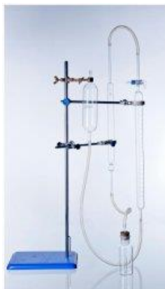
Slika 2. Scheiblerov kalcimetar ( www.ziglass.rs )
