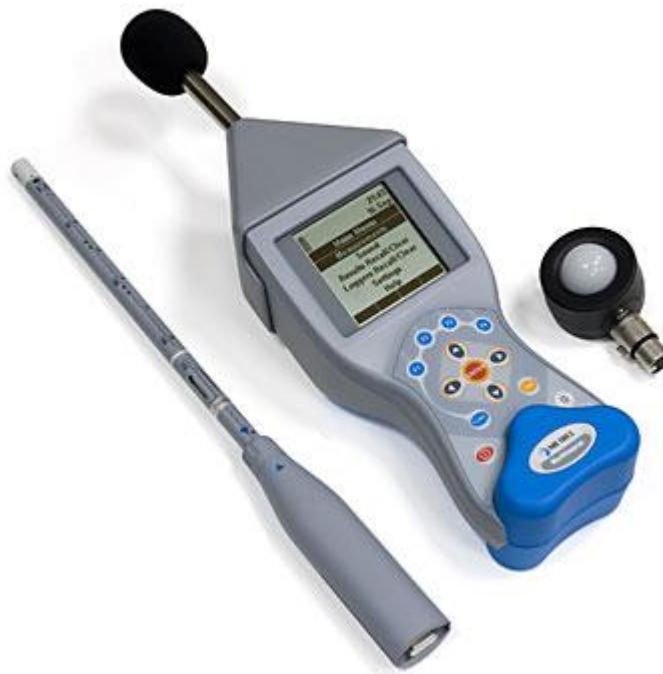
Slika 4. Uređaj za mjerjenje buke Metrel Multinorm MI 6201 EU
