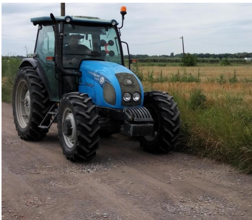
Slika 6. Vožnja i mjerenje buke po makadamskoj podlozi
