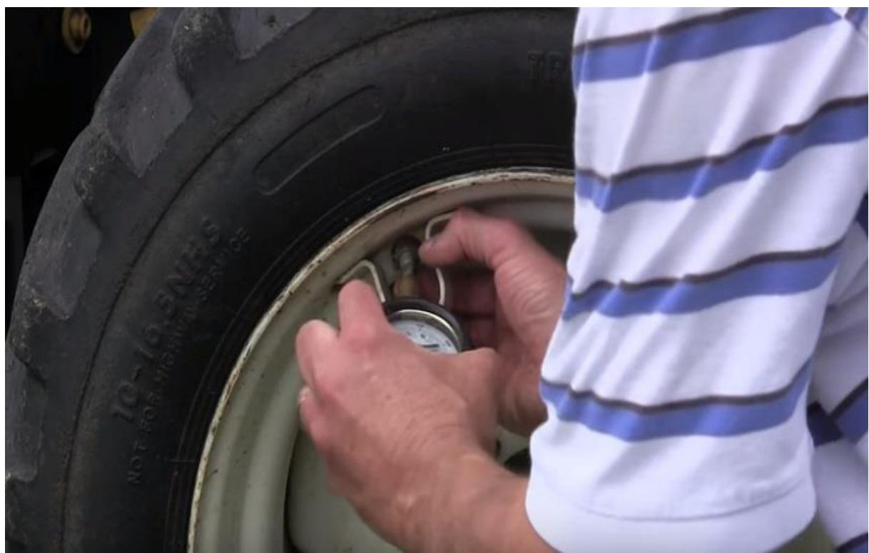
Slika 9. Provjera tlaka u pneumaticima (Izvor: Vlastita fotografija.)
