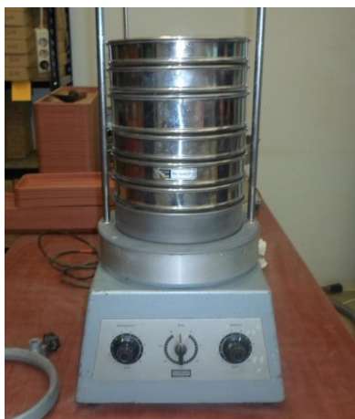
Slika 24. Električni uređaj „RHEWUM“ za prosijavanje tla (Izvor: Vlastita fotografija)
