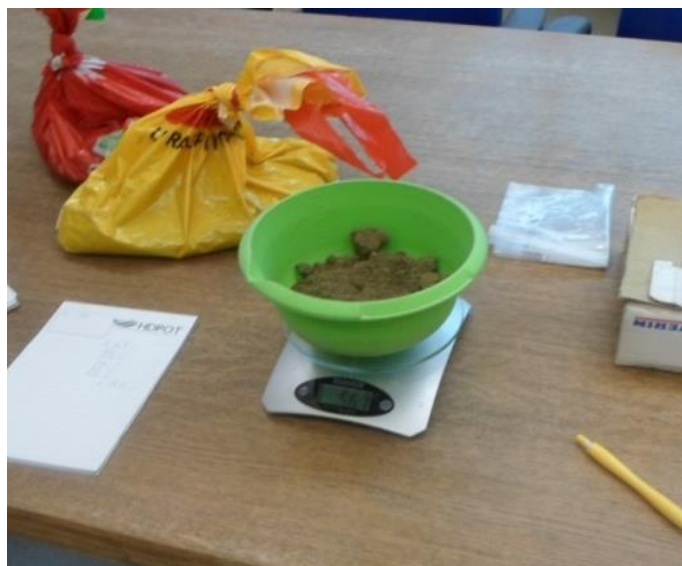
Slika 23. Vaganje uzorka prije prosijavanja (Izvor: Vlastita fotografija)
