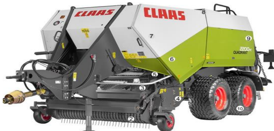
Slika 4. Dijelovi prese: 1. Upravljač, 2. Pick up uređaj, 3. Dupli rotor sa 4 zvijezde, 4. Roto rezač sa 25 noževa, 5. 3 progresivna ciklusa punjenja po jednom udaru klipa, 6. Interaktivna sigurnost između ulagača i podizanja, 7. 51 klip udubljenja, 8. 6 krakova jedno komponentnih čvorova bez ostataka niti, 9. 4 hidraulična kompresijska cilindra za više gustoće, 10. Kotači
