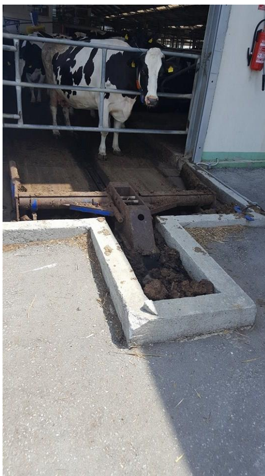
Slika 9. Uređaj za izbacivanje gnoja iz staje
