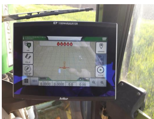
Slika 14. „AvMap“ - GPS sustav navođenja
