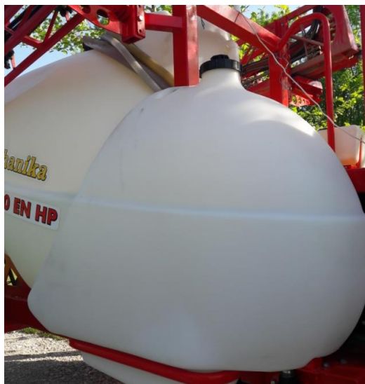
Slika 8. Spremnik za ispiranje
