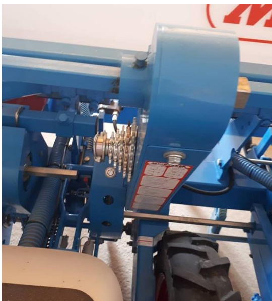
Slika 9. Glavni mjenjač za količinu mineralnog gnojiva (Izvor: Vlatko Gojević)
