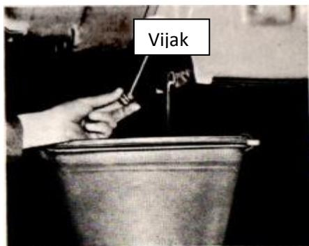
Slika 2. Izmjena ulja u motoru
