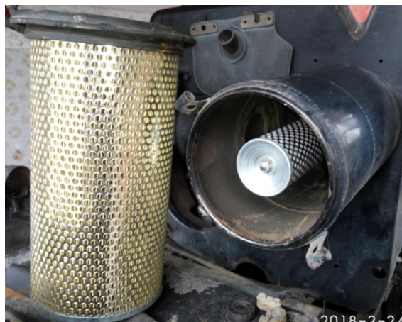
Slika 12. Grubi i fini suhi pročistač (izvor: autor)
