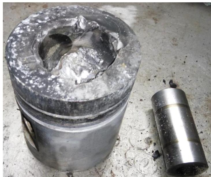
Slika 20. Oštećen klip i osovinica klipa (izvor: autor)
