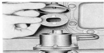
Slika 37. Čišćenje sita na crpki niskog tlaka
