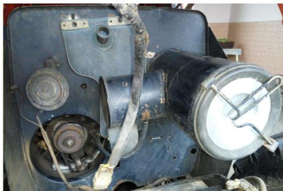
Slika 11. Izgled kućišta sa suhim pročistačem (izvor: autor)
