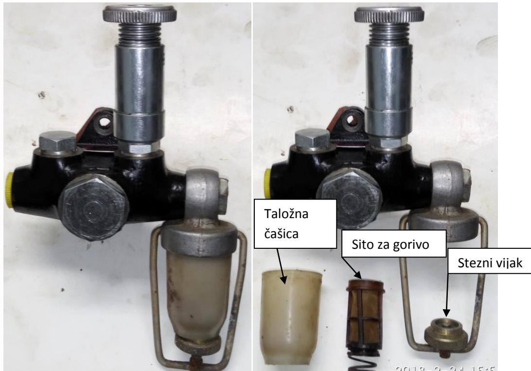
Slika 8. Sastavljena i rastavljena taložna čašica na crpki niskog tlaka (izvor: autor)
