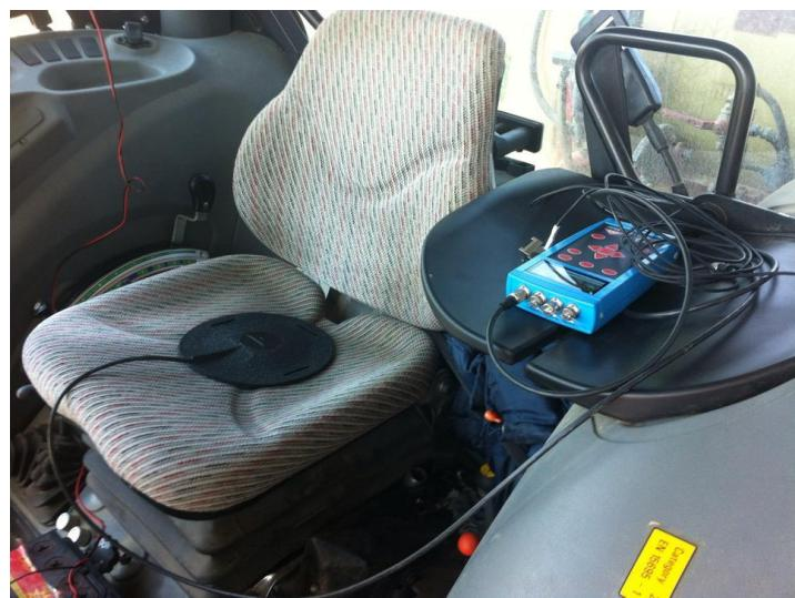
Slika 9. Uredaj za mjerenje razine traktorskih vibracija (vlastita fotografija)
