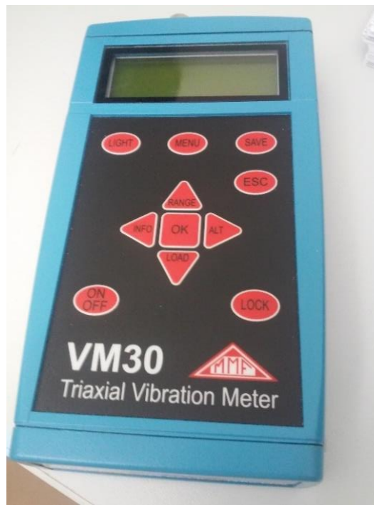
Slika 14. Uređaj za mjerenje vibracija MMF VM30 (vlastita fotografija)
