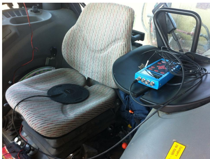
Slika 9. Uređaj za mjerenje razine traktorskih vibracija (vlastita fotografija)
