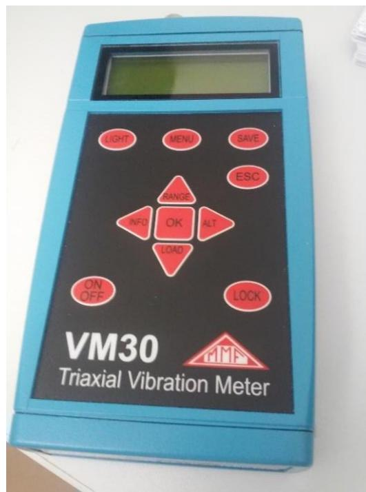
Slika 14. Uredaj za mjerjenje vibracija MMF VM30 (vlastita fotografija)
