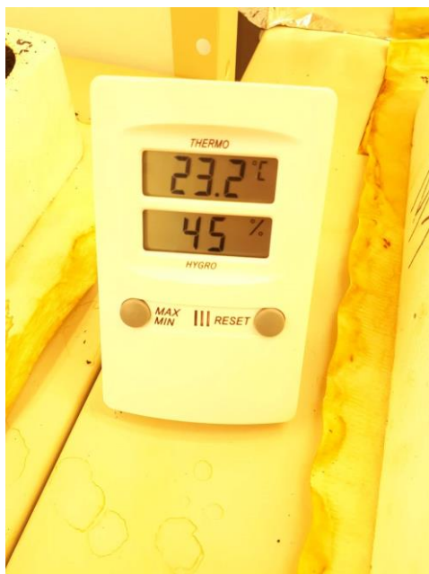
Slika 15. Termostat sa prikazom temperature i vlage u klima komori (foto original)
