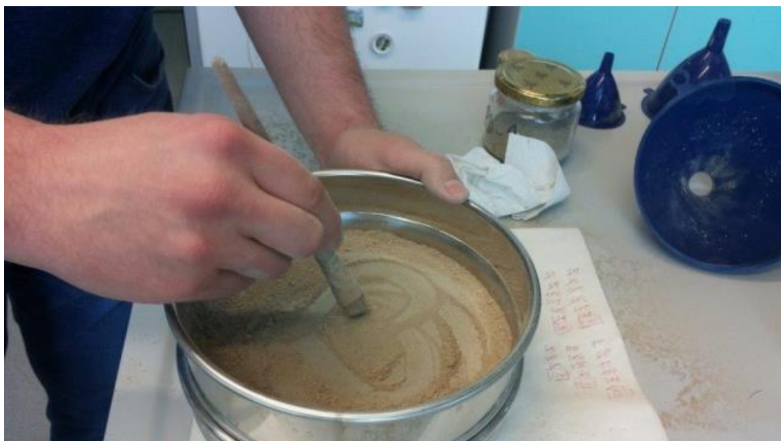
Slika 12. Prosijavanje prašiva (Izvor: Lucić, P.)
