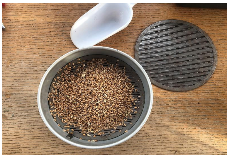
Slika 3. Prosijavanje primjese pšenice kroz sita (Izvor: Pušelja, N.)
