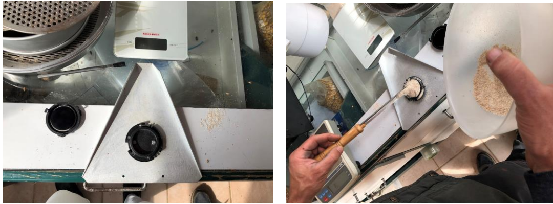
Slika 5 a i b. Stavljanje uzoraka na predmetno stakalce (Izvor: Pušelja, N.)
