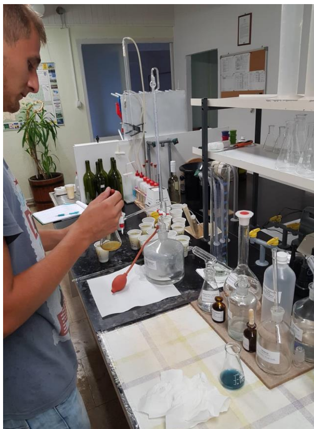
Slika 9. Rad u laboratoriju (određivanje ukupnih kiselina) (Izvor: autor)
