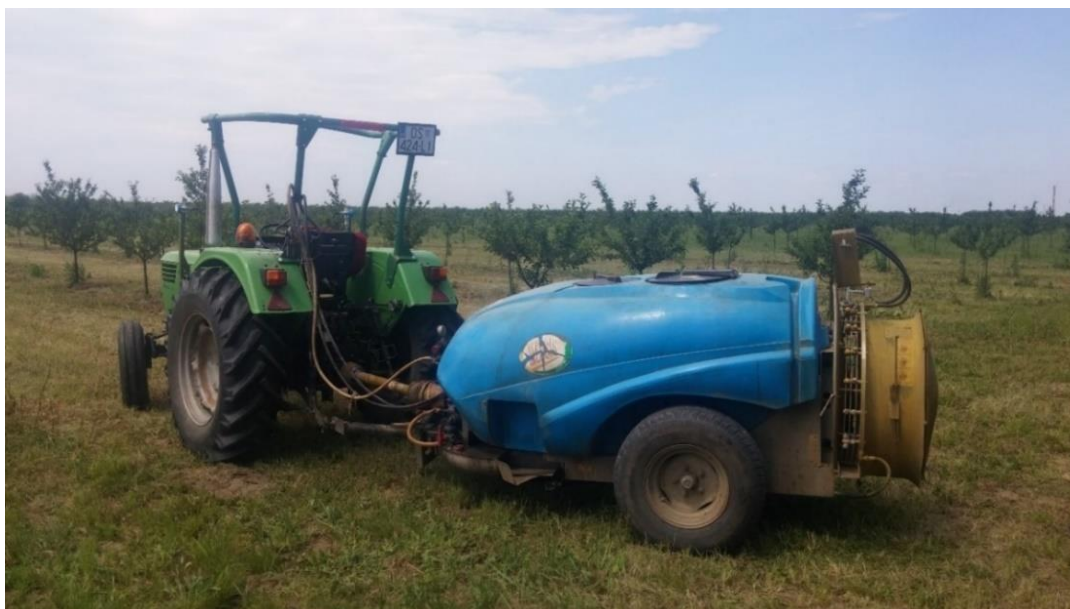
Slika 9. Vučeni raspršivač Tifone Vento 1500
