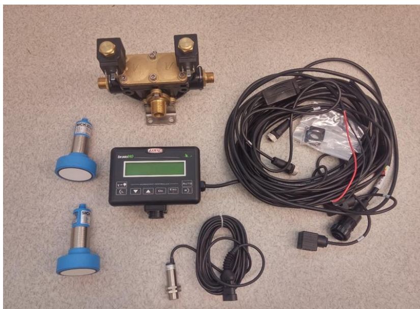
Slika 7. Sustav ultrazvučnih senzora Autor: D. Petrović
