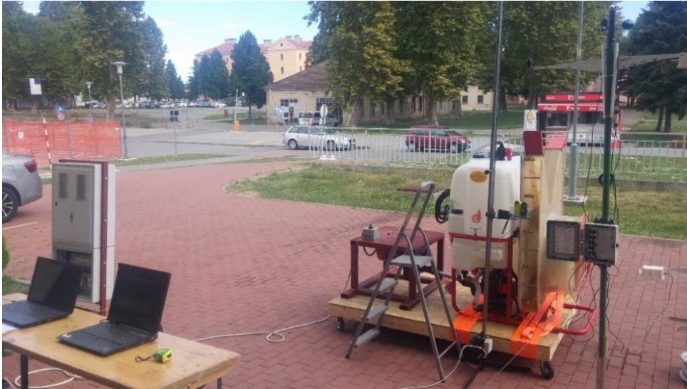
Slika 15. Mjerenje vertikalne raspodjele zraka anemometrom Kestrel 4500 BT
