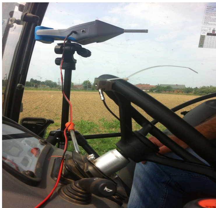
Slika 6. Uređajem za mjerenje buke proizvođača METREL tipa Multinorm MI 6201 EU (vlastita fotografija)
