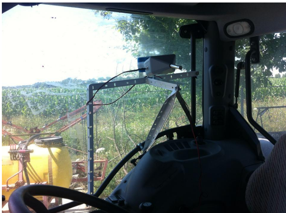
Slika 3. Postavljanje uređaja za mjerenje buke (vlastita fotografija)
