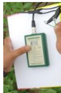
Slika 2. Watermark uređaj (foto original; D. Galić Subašić)
