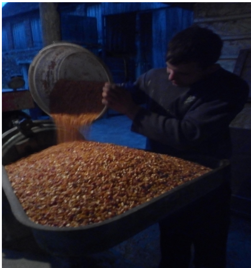
Slika 8. Usipni koš mlina čekičara (Izvor: Ivana Mirković)
