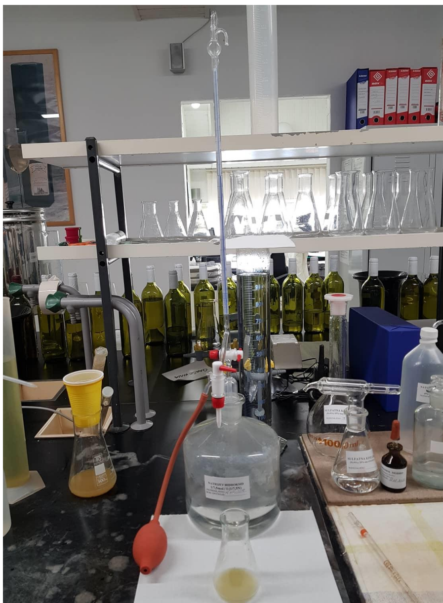
Slika 9. Uređaj za titriranje (Izvor: Čopčić T., 2018.)
