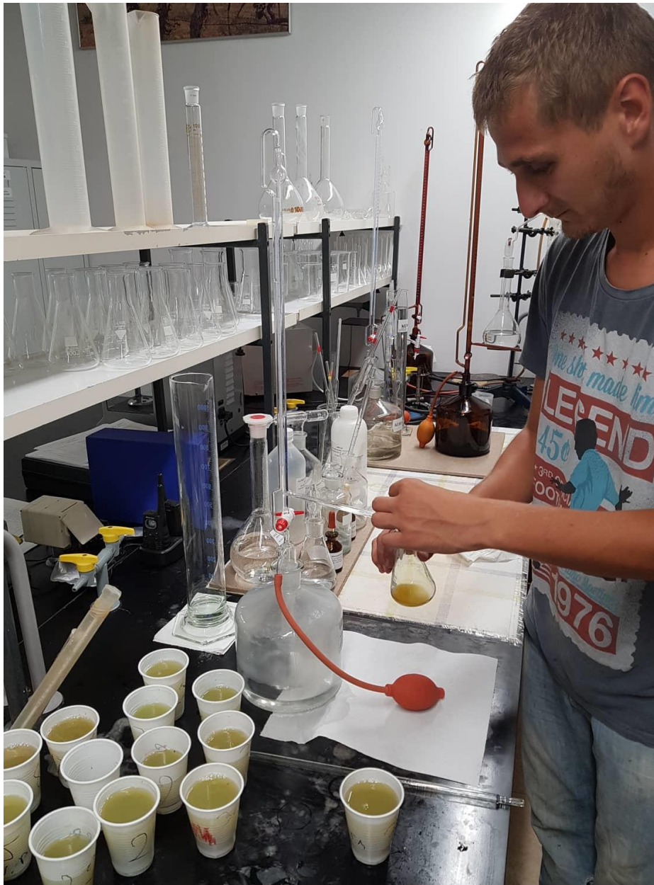
Slika 10. Postupak titracije (Izvor: Čopčić T., 2018.)
