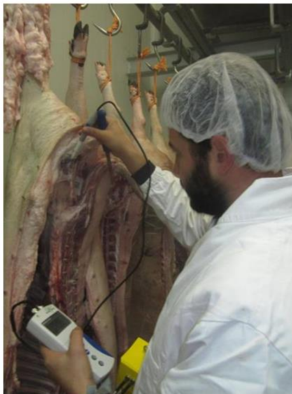
Slika 12. Mjerenje pH vrijednosti u butu (Izvor: Arhiva Katedre za animalne proizvode, Fakultet Agrobiotehničkih znanosti Osijek)
