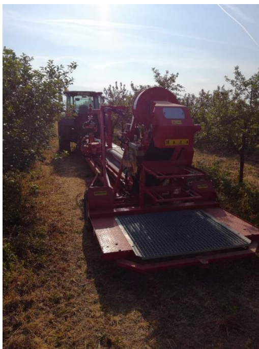
Slika 5. Tresač "Weremczuk" Maja agregatiran na traktor (Vlastiti izvor)
