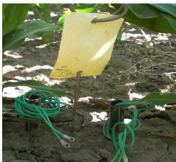
Slika 9. Elektrode Watermark senzora
