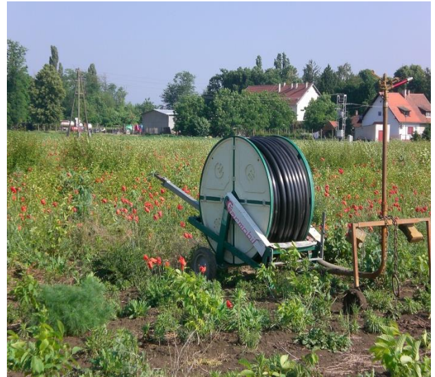
Slika 2. Samohodni sektorski rasprskivač
