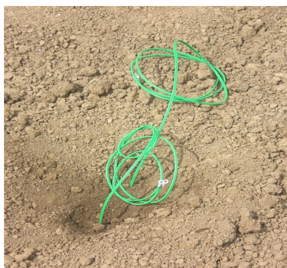
Slika 12. Senzori ukopani u tlo sa elektrodama na površini tla
