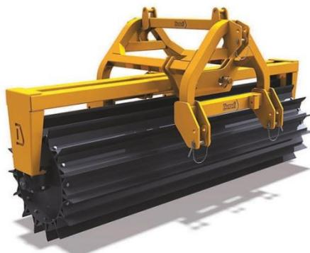
Slika 10. Valjak za usitnjavanje biljnih ostataka (Izvor: [www.messis.hr](http://www.messis.hr))
