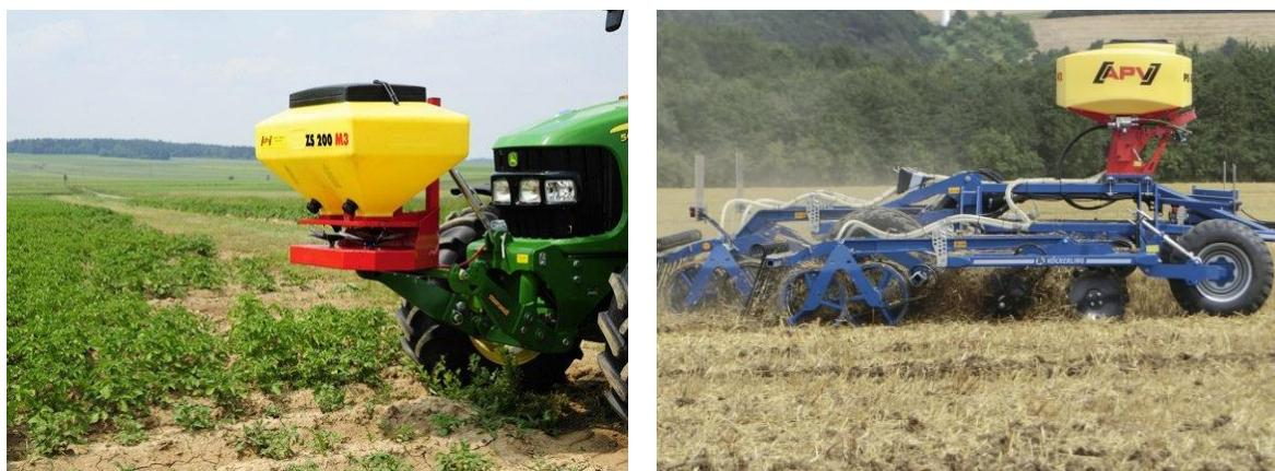
Slika 9. Uređaj za sjetvu siderata na prednjem podiznom uređaju (lijevo) i postavljeno na stroj u radu (desno) (Izvor: [www.apv.at](http://www.apv.at))
