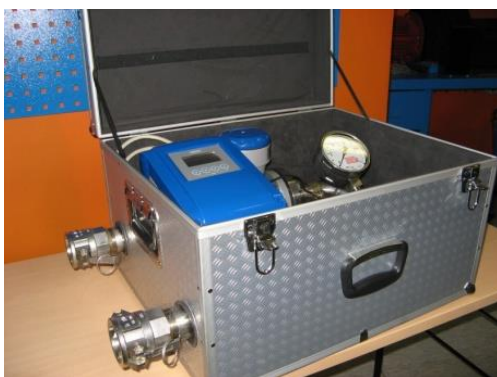
Slika 10. Elektromagnetski mjerač protoka crpke tvrtke Krohne
