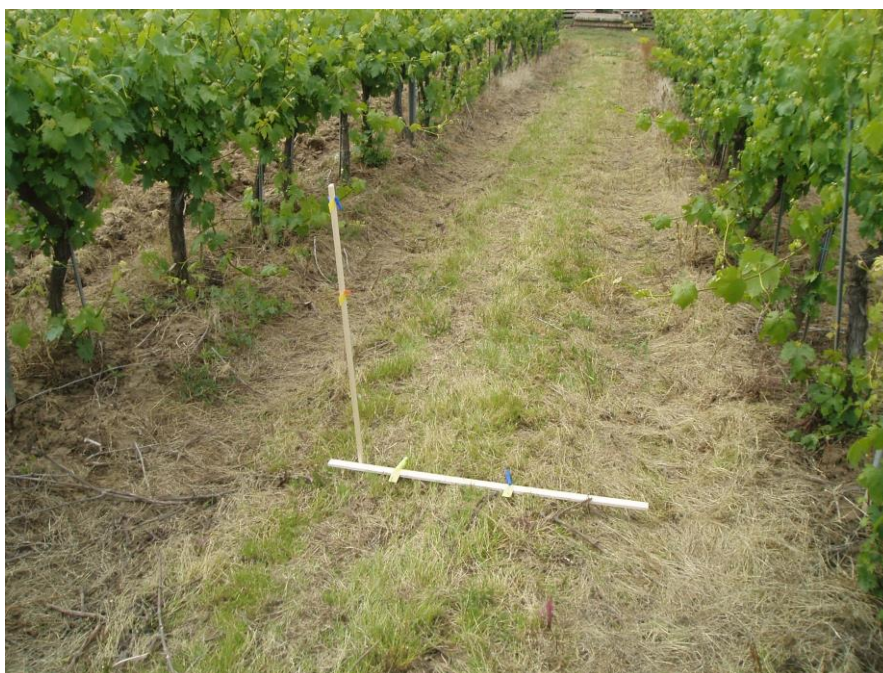
Slika 28. Mjerenje zanošenja sa vodoosjetljivim papirićima
