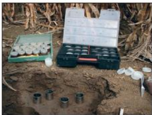
Slika 6. Uzorkovanje tla u prirodnom nenarušenom stanju u cilindre Kopecki (Izvor: autor prema Lončarić i sur., 2014.)
