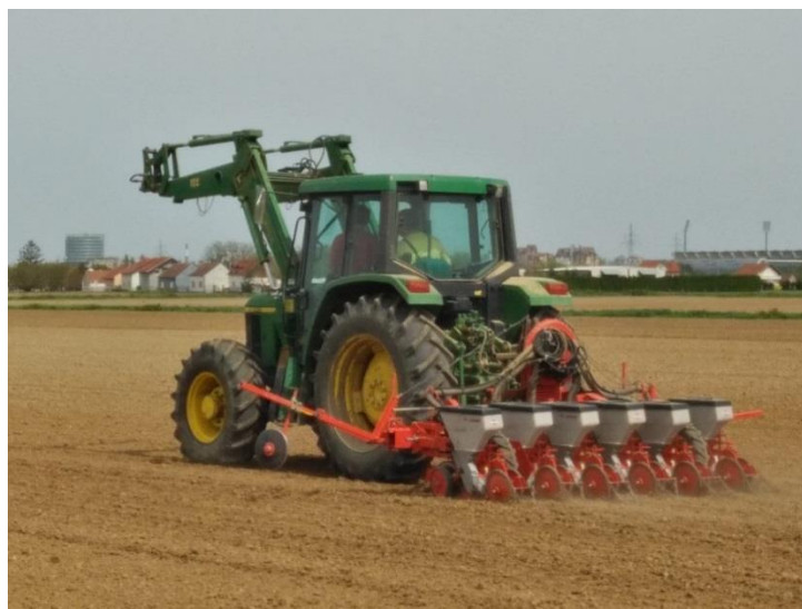
Slika 1. Sjetva pokusa soje sijačicom Kuhn (model PL Junior) (foto: orig.)
