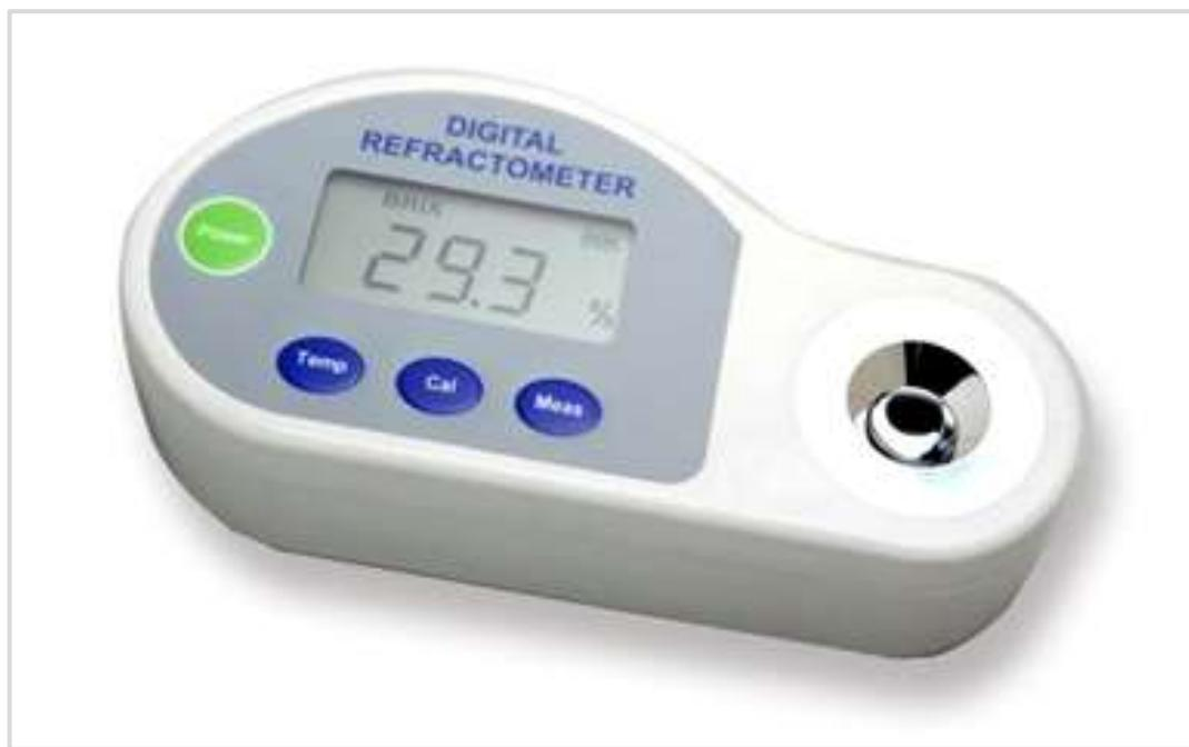
**Slika 8.** Digitalni Brix refraktometar
