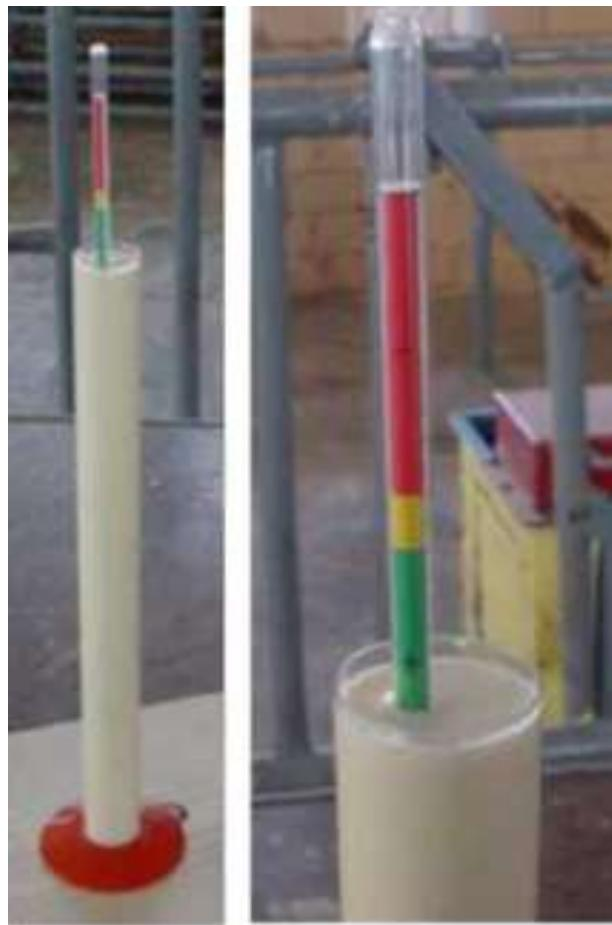
**Slika 7.** Kolostrometar pluta u uzorku kolostruma
