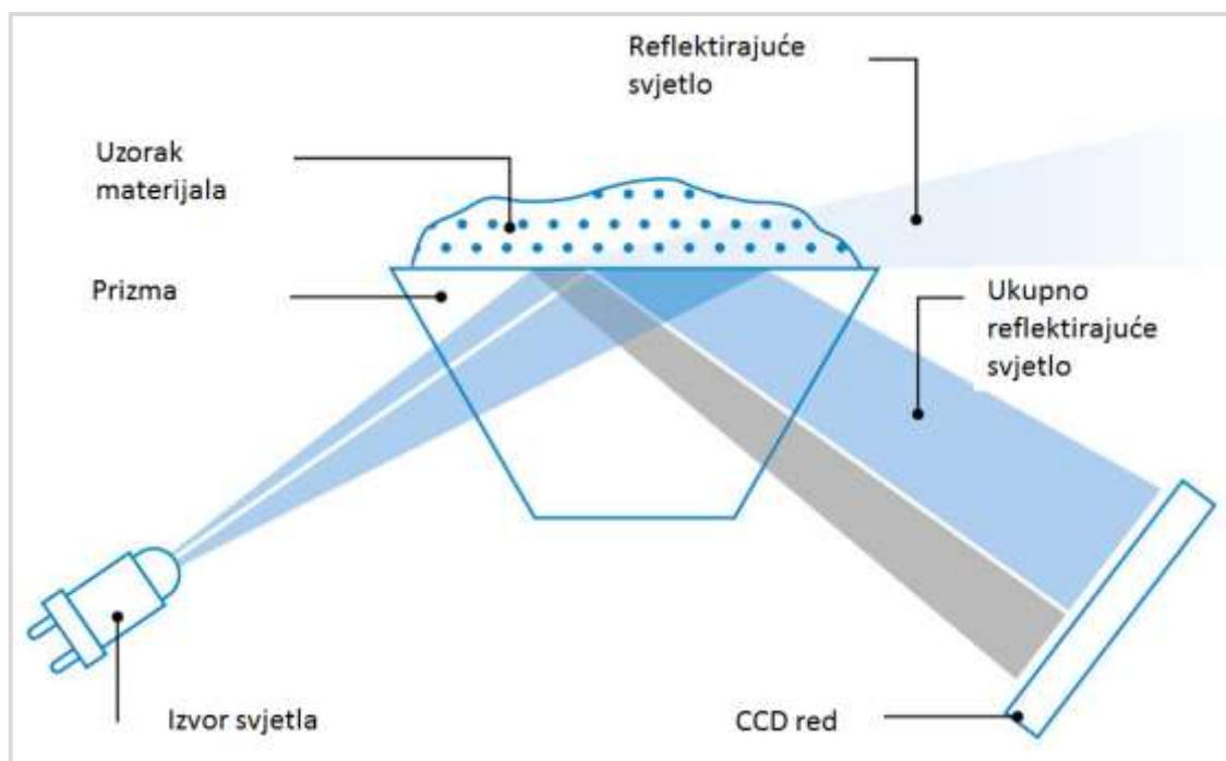
**Slika 16.** Princip refraktometrije
