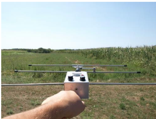
Slika 30. i Slika 31. Prijamnik za lakše pronalaženje trčki (fotografije Viktor Šegrt)
