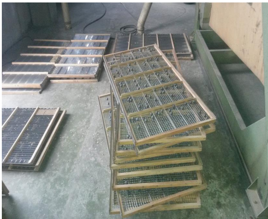
Slika 16. Sita uređaja za čišćenje (Izvor: vlastita fotografija)
