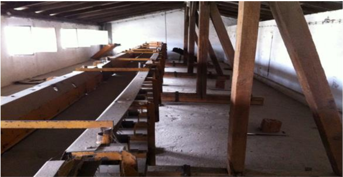
Slika 8. Trakasti transporter iznad binova za sušenje kukuruza (Izvor: vlastita fotografija)
