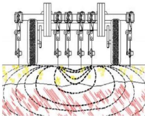
Slika 11. Shematski prikaz rada Coulter elektroda
