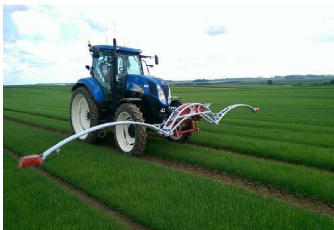
Slika 39. Fritzmeier senzori usjeva
