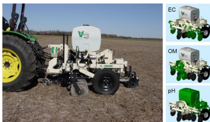
Slika 12. Veris MSP3 sa sensorima za mjerenje induktivnosti tla (EC), organskog sadržaja (OM) i pH tla (pH)
