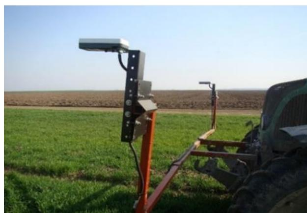
Slika 26. Način postavljenja OptRx senzora na traktor Fendt 716 Vario Belje d.d.
