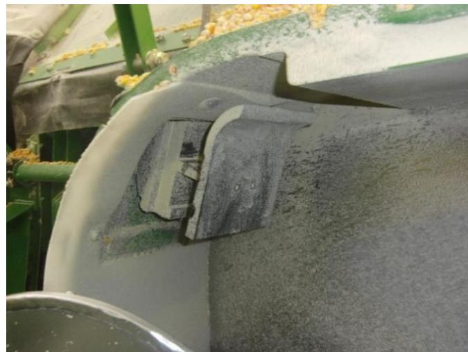
Slika 69. Senzor udara – protoka mase u eksplotacijskim uvjetima
