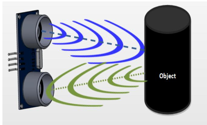
Slika 5. Ultrazvučni senzor
