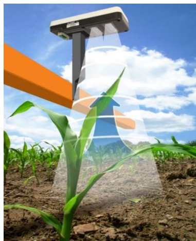
Slika 18. Princip rada OptRx senzora
