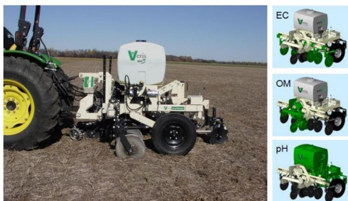
Slika 12. Veris MSP3 sa senzorima za mjerjenje induktivnosti tla (EC), organskog sadržaja (OM) i pH tla (pH)
