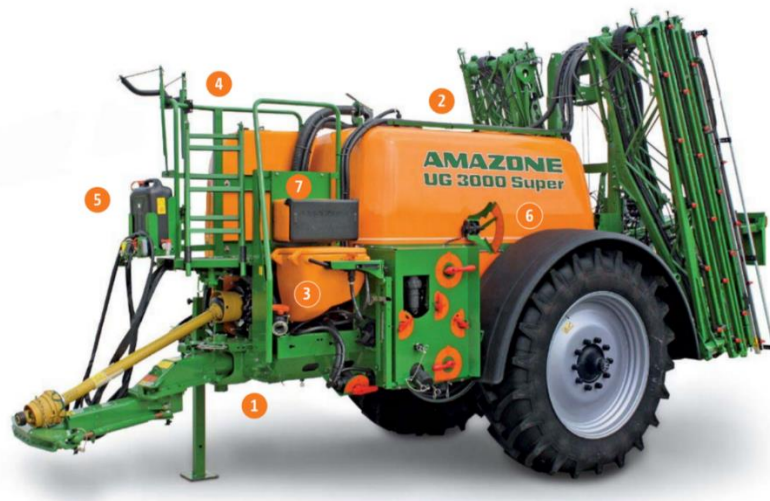
Slika 60. Konstrukcija prskalice Amazone UG 3000 (Izvor: http://et.amazone.de/files/pdf/mg3506.pdf )
