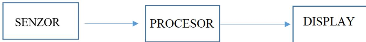
Slika 1. Shematski prikaz tri osnovna dijela mjernih pretvarača
