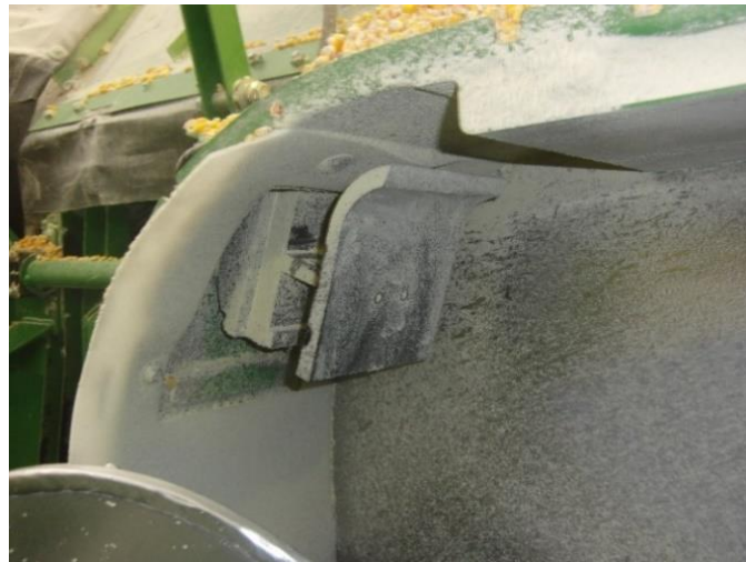
Slika 69. Senzor udara – protoka mase u eksploatacijskim uvjetima
