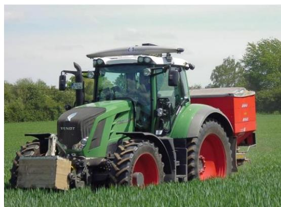
Slika 40. *Yara* dušični senzori postavljeni na kabinu traktora
