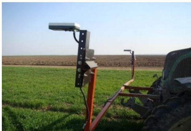
Slika 26. Način postavljenja OptRx senzora na traktor Fendt 716 Vario Belje d.d. (Izvor: Marić, 2015)
