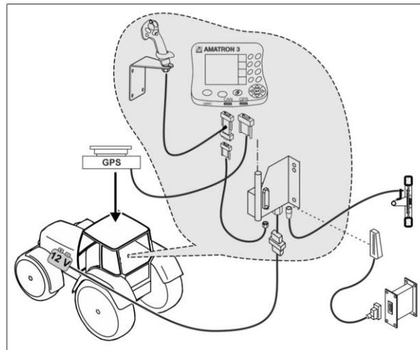
Slika 61. Shematski prikaz spajanja AMABUS sustava prskalice
