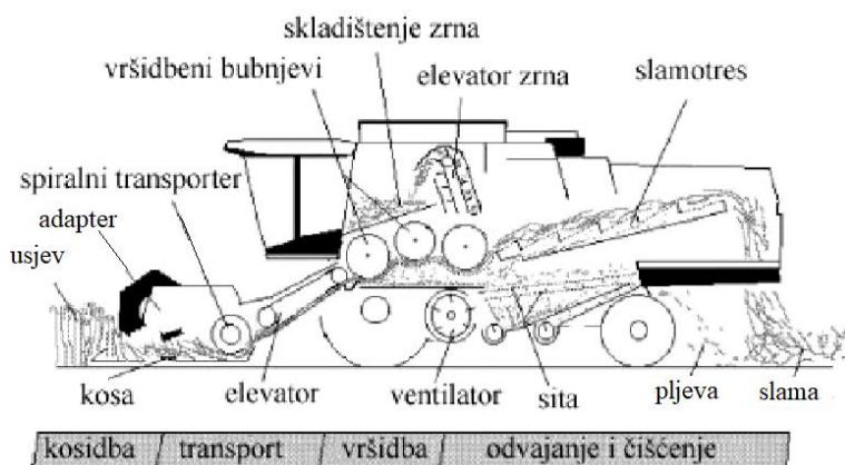
Slika 63. Procesi koji se odvijaju na žitnom kombajnu sa klasičnom tehnološkom shemom
