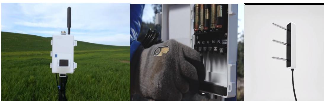
Slika 9. Uređaj EM50 sa senzorom za ispitivanje induktivosti tla proizvođača *Meter*
