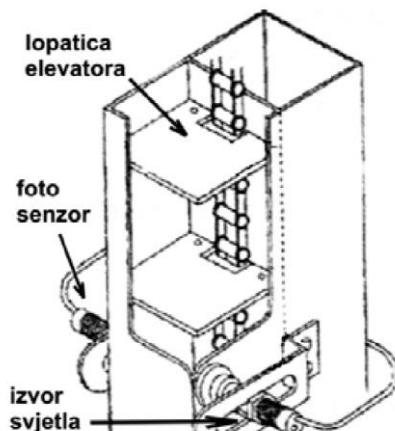
Slika 70. Shematski prikaz principa mjerena obujma
