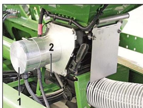
Slika 55. Prikaz elektromotora (1) i komore dozirnog valjka (2)
