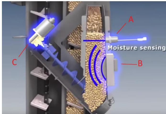
Slika 73. Sustav mjerjenja vlage čistoga zrna
