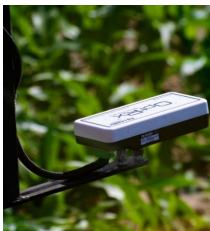
Slika 17. AgLeader OptRx senzor
