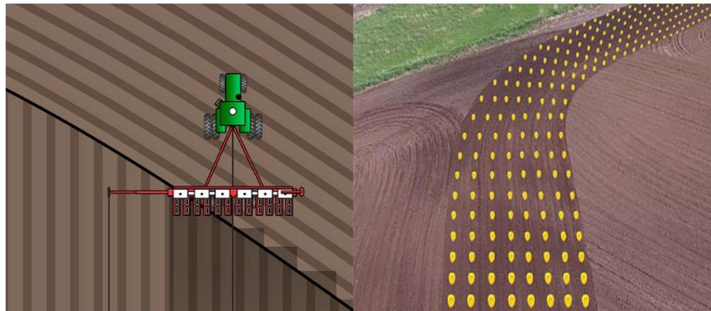
Slika 16. Prikaz sjetve *SureDrive* uređajem
