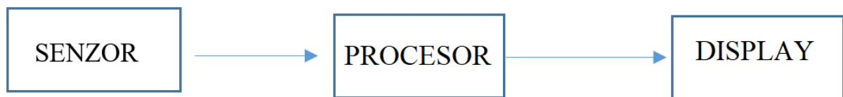
Slika 1. Shematski prikaz tri osnovna dijela mjernih pretvarača
