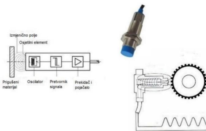
Slika 2. Induktivni senzor
