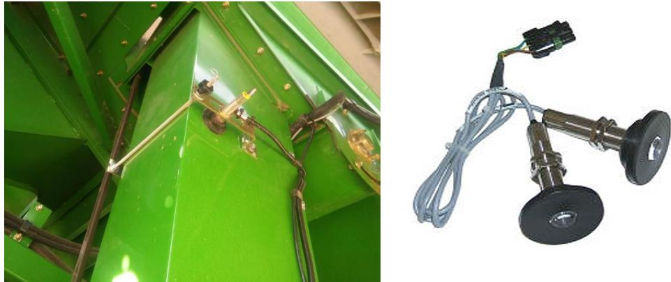
Slika 71. Naknadno postavljeni sustav mjerena obujma zrna i fotosenzori sustava (desno)
