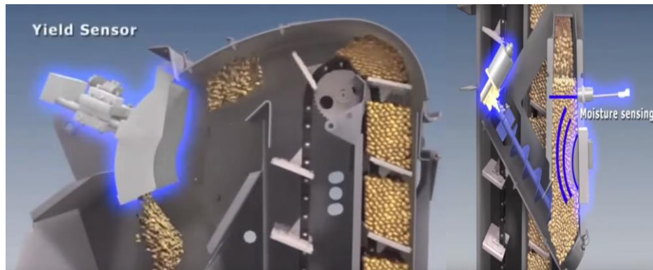
Slika 68. Naglašeno plavom bojom – senzor udara (lijevo); senzor vlage (desno)
