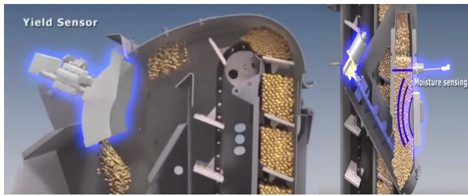
Slika 68. Naglašeno plavom bojom – senzor udara (lijevo); senzor vlage (desno)
