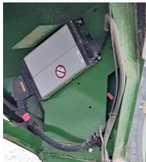
Slika 57. ISOBUS modul sijačice
