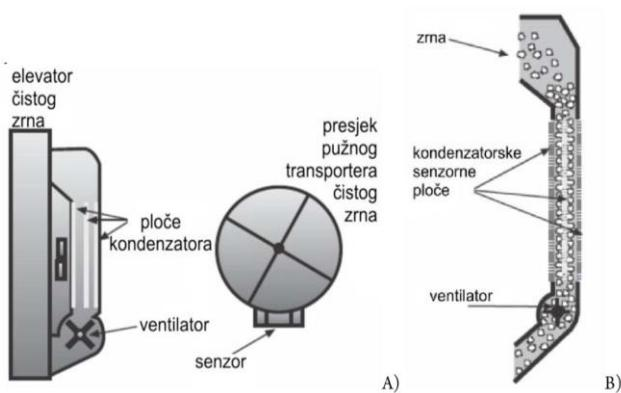
Slika 72. (A) Shematski prikaz senzora za vlagu u sustavu za monitoring prinosa
