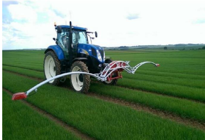
Slika 39. Fritzmeier senzori usjeva
