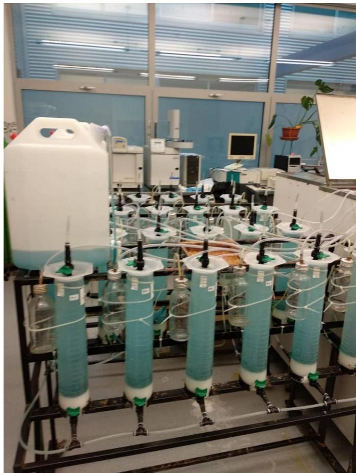
Slika 10. Provjera procesa anaerobne fermentacije
