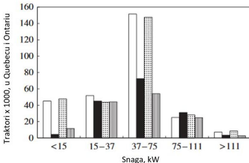
Slika 2. Usporedba brojeva traktora zabilježenih (SC) i simuliranih (F4E2) u svakoj od pet klasa snage (veličine) za 1991. i 1996. u Quebec i Ontario regiji Kanade: □ SC-1991; ■ F4E2-1991; ▨ SC-1996; ▩ F4E2-1996 (Dyer i Desjardins, 2005.)
