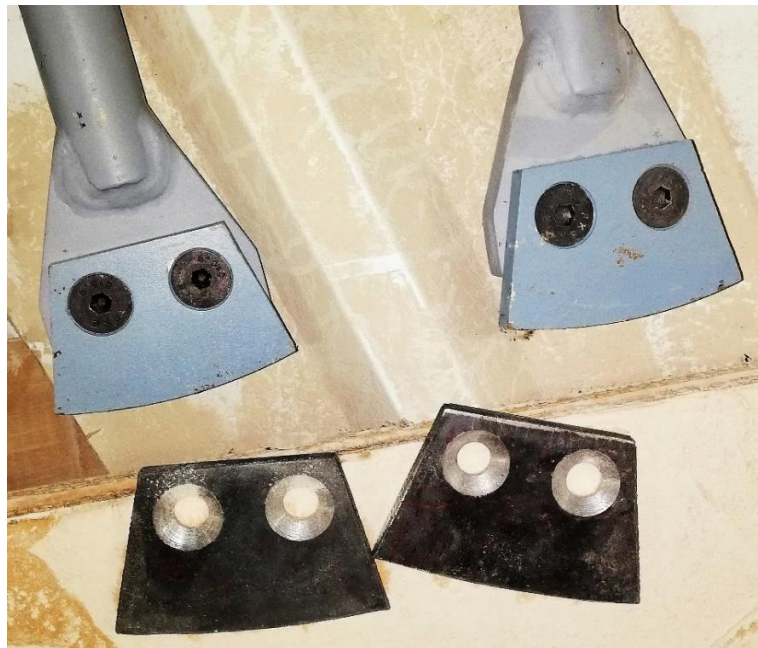
Slika 31. Lopatice homogenizatora (Fotografija: Janješić, 2019.)
