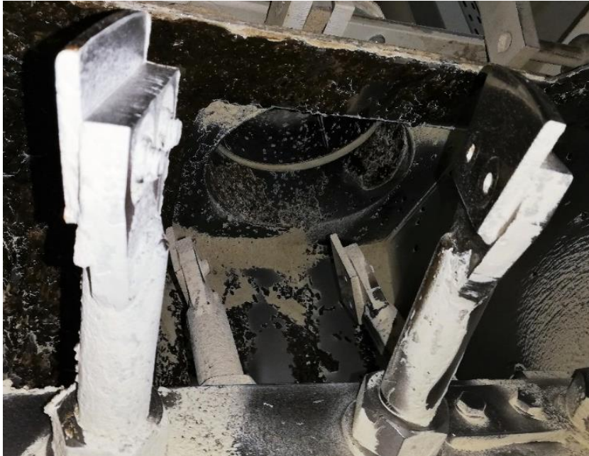
Slika 36. Lopatice na ulaznom otvoru homogenizatora (Fotografija: Janješić, 2019.)
