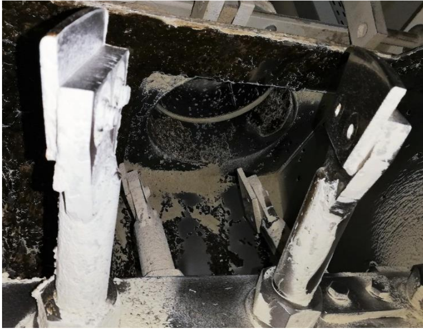
Slika 36. Lopatice na ulaznom otvoru homogenizatora (Fotografija: Janješić, 2019.)
