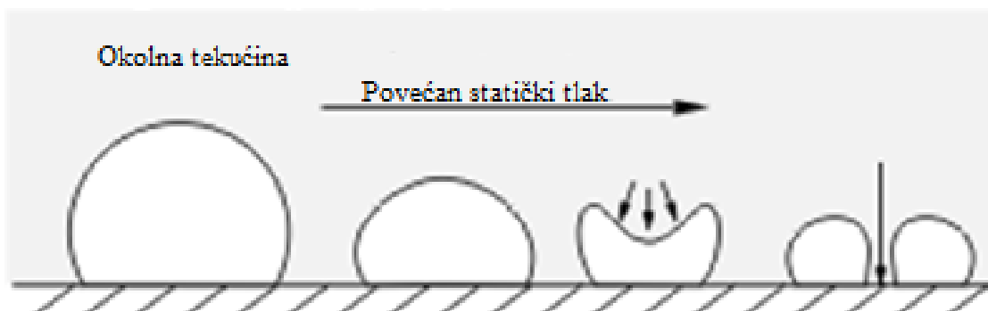
Slika 16. Shema kavitacijskog trošenja (Izvor: https://en.wikipedia.org/wiki/Cavitation#/media/File:Cavitation_bubble_implosion.png )
