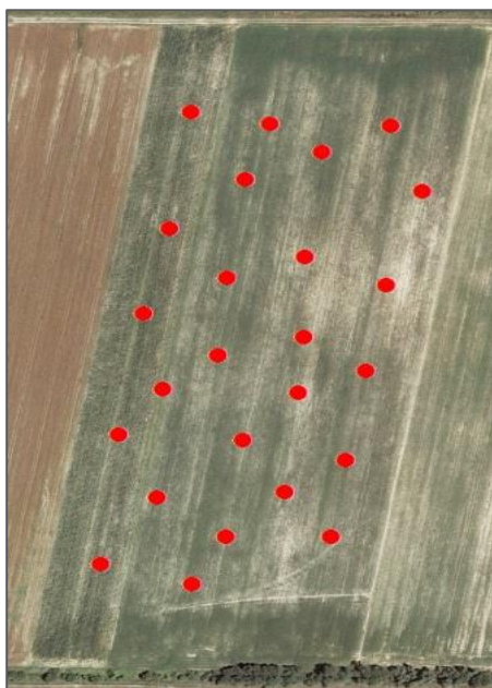
Slika 3. Shema uzorkovanja metodom slučajnog rasporeda uzoraka
