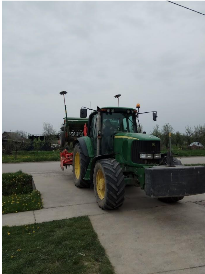
Slika 12. Sjetvena kombinacija sijačice i rotodriljače (Izvor: M. Kuric)
